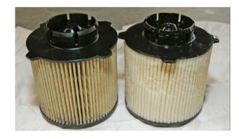
Verstopfte Treibstofffilter durch kristallisierte Dieselkomponenten
